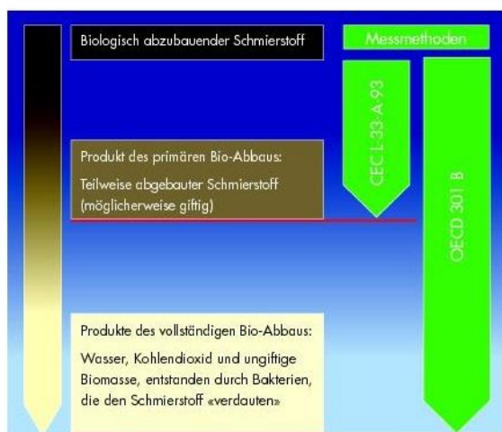
Abb. 1: Vergleich des Primären biologischen Abbaus mit dem Vollständigen biologischen Abbau eines Schmierstoffes
