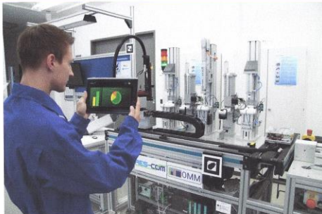
Kontextsensitive Informationsbereitstellung für den Werker in der Fabrik durch den Einsatz eines neuartigen Assistenzsystems (DFKI)
