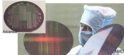
Chipindustrie: Nicht nur Massenware. Multiprojektwafer erlauben die Fertigung kundenindividueller Chips in kleinsten Stückzahlen mit hoch-standardisierten Prozessen/Maschinen.
