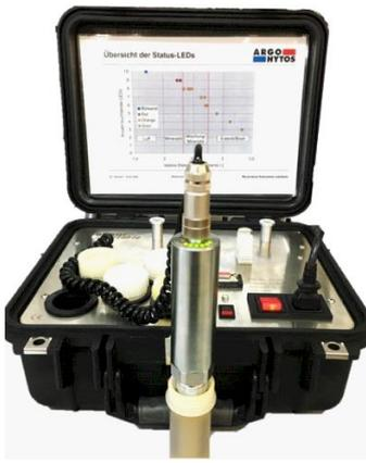
Abb. 6: Prüfkoffer von ARGO-HYTOS für den Schnelltest von "Bioölen" (Bild: K. Lippert)
