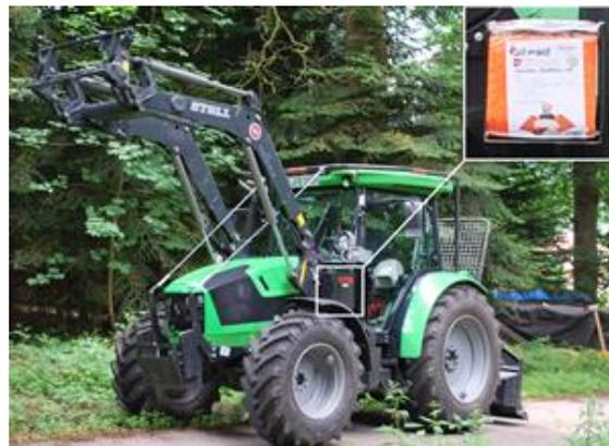
Abb. 4: Forstschlepper mit Ölunfallset (Bild: K. Lippert)
